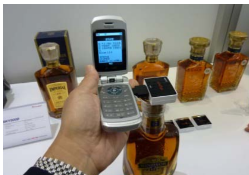
図 携帯電話で UHF タグ読み取り、高級ウイスキー偽造品を排除
