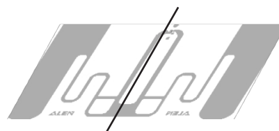
インレイはz軸を中心にx、y平面内で回転されています 角度感度
