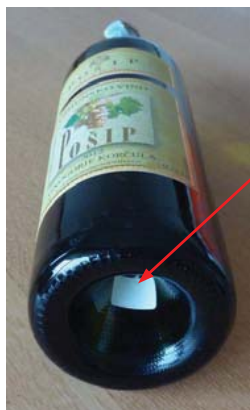
ワインボトルの底にタグを貼る。 ボトルの底面、側面の両方から タグを読み取ることができる。
