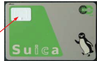
Suica カードに SIT タグを貼る UHF 帯の ID カードとしても使える
