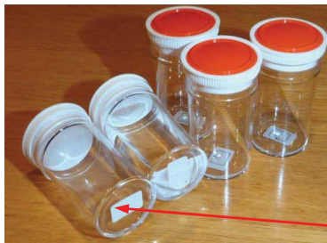
プラ試験瓶の底にタグを貼る
