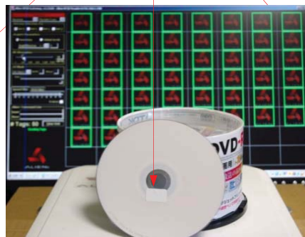
DVD メディアのハブにタグを貼る。 底面、側面の両方からタグを読む ことができる。アンテナの上にメディア 50 枚を置いて一括読み取りできる。
