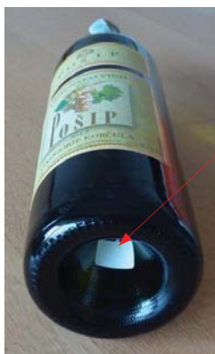
ワインボトルの底にタグを貼る。 ボトルの底面、側面の両方から タグを読み取るができる。
