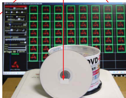
DVD メディアのハブにタグを貼る リーダーアンテナに重ね置き 50 枚の一括読み取りが可能
