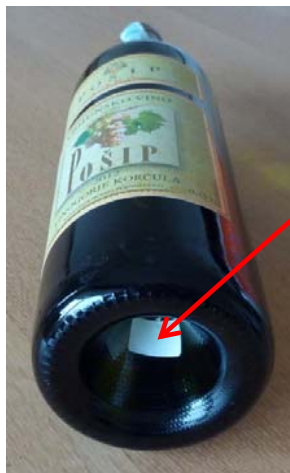
ワインボトルの底にタグを貼る。ボトルの底面、側面のいずれの方向からもタグを読むことができる。
