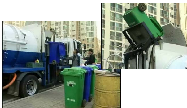
図3 大型生ゴミ回収車の車載端末で容器のRFタグを認識、計量して生ゴミを回収
