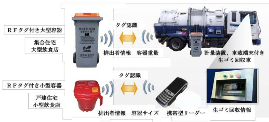
図2 生ゴミ計量、回収方式 (排出量別)
