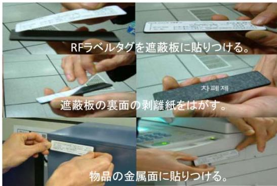
図3. 遮蔽型金属タグの使用方法
